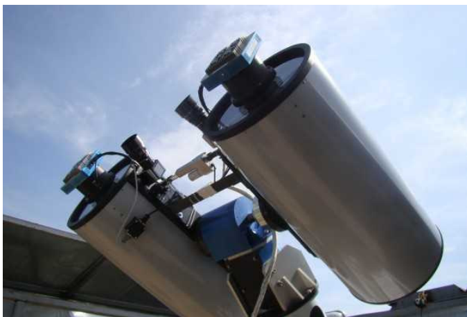
Рис. 5. Сдвоенный 40-см телескоп Глобальной роботизированной сети МАСТЕР, установленный на полигоне Иркутского ГУ в Тункинской долине под г. Иркутск.
